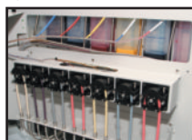
Alimentation automatique des têtes prévenant la formation de bulles d'air
